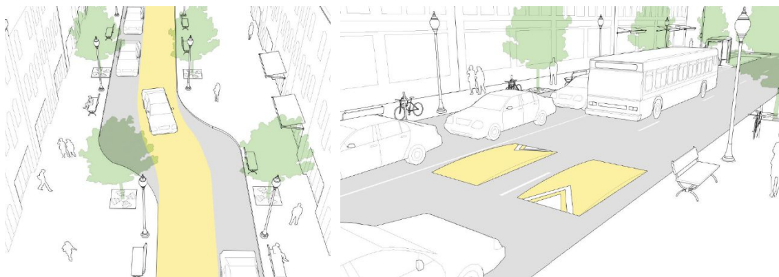
Fig. 62 Exemplos de soluções a implementar em Zonas 30 para a redução da velocidade
