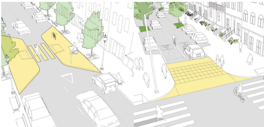
Fig. 61 Exemplos de soluções a implementar em Zonas 30 para o aumento da segurança nos atravessamentos Fonte: NACTO, 2016
