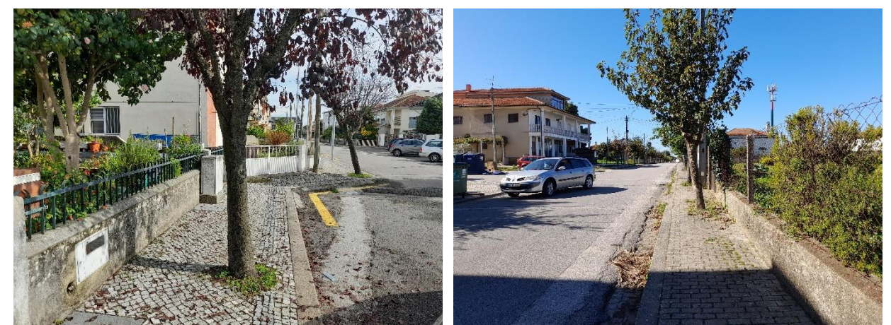
Figura 16. Exemplos de árvores a obstruir o percurso pedonal
